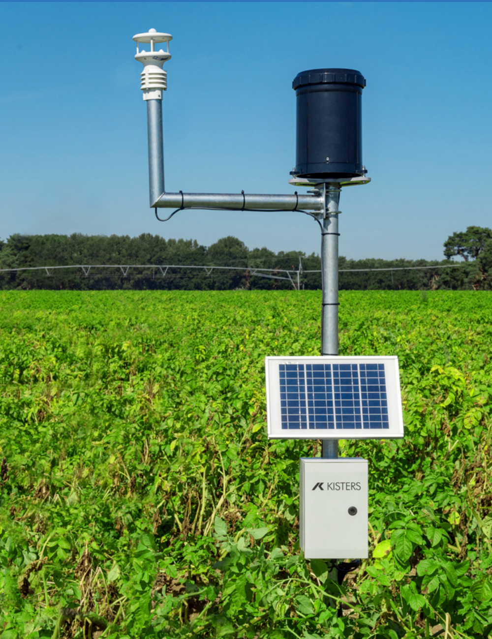
FieldRay Plant Protection – Agrarmeteorologische Überwachungsstation: Regenmesser mit Solarpanel (links), Wetterstation zur Messung von Windgeschwindigkeit, Sonneneinstrahlung, Temperatur, relativer Luftfeuchtigkeit und Windrichtung (rechts)
