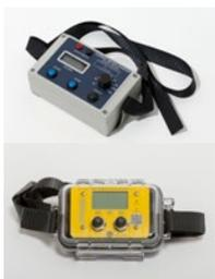
**Contadores de molinete** (varios modelos), características: carcasas herméticas, menús sencillos controlados mediante botones, pantallas LCD incorporadas y alertas
