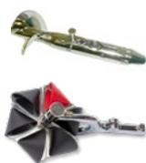
**Molinetes mecánicos:** KISTERS ofrece varios modelos, por ejemplo, el OSSB1 (molinete universal) y Red Back (molinete tipo copa) con un avanzado sistema de conmutación de contacto que permite la medición del flujo de agua en arroyos, canales abiertos, tuberías de presión, lagos y mares a un grado muy fino de precisión y repetibilidad.
