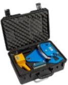
**Flying Fox:** Sistema portátil de remolque y posicionamiento con motor eléctrico y control remoto incorporados. Al igual que el CFX, el FFX es un dispositivo portátil para posicionar ADCPs
