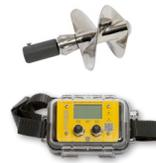
**Molinetes (p. Ej., OSS-B1), contadores molinetes y pesos de medición:** HyQuest Solutions proporciona el equipo completo para mediciones móviles con equipos de medición suspendidos. El peso de medición protege el molinete contra daños por escombros pesados. Su forma optimizada reduce la resistencia al flujo de agua.
