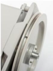
**Polea y cable:** La polea motriz puede utilizarse tanto con cables rectos como con líneas perladas. Los orificios equidistantes de la polea motriz acomodan las perlas de
