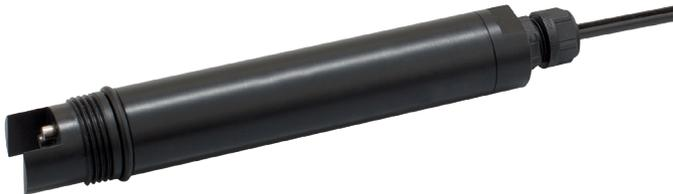
Leitfähigkeitssensoren sind Messgeräte, welche die Fähigkeit eines Messmediums messen, elektrischen Strom zwischen zwei Elektroden zu leiten. Der Strom fließt durch Ionentransport. Das bedeutet, dass Messmedien mit einer höheren Ionenzahl den Strom besser leiten.
