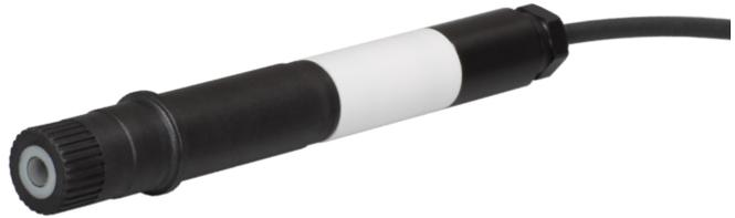
Robuste digitale pH-Sonde zum Betrieb an TriBox-Controllern und HS100 Hutschienen G2 Modul. Die digitale Kommunikation gewährleistet eine sichere und störungsfreie Signalübertragung von der Sonde zum Controller. Die hochwertige Gel-pH-Elektrode verfügt über ein Lochdiaphragma und ist schmutzunempfindlich. Somit ist diese Sonde für Abwasserapplikationen gut geeignet.
